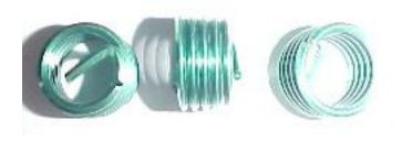
Gewindeeinsätze Helicoil plus Nachfüllpack mit 10 Stück M 8 Länge 1,5 x D (12 mm)
